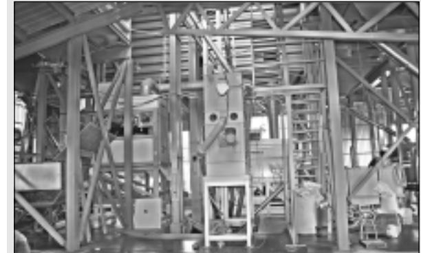
Sēklas graudu sagatavošanas līnija ar tīrišanas iekārtu "Damas", kas ļauj sagatavot no 5 līdz 15 tonnām graudu stundā. Graudu pieņemšanas un izdošanas punkts. Te uzstādīts 21 bunkurs ar ietilpību 40 tonnas katrs.
