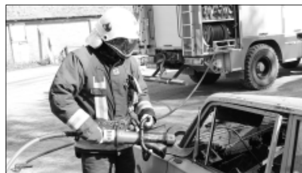
Darbojas ar hidraulisko griezēju. Attēlā redzamo instrumentu ugunsdzēsēji glābēji izmanto ne tikai automašīnas statņu griešanai, lai varētu atbrīvot cilvēku no transportlīdzekļa, bet arī tērauda armatūras pārkniebšanai un plānsienu trubu griešanai sagruvumos.
