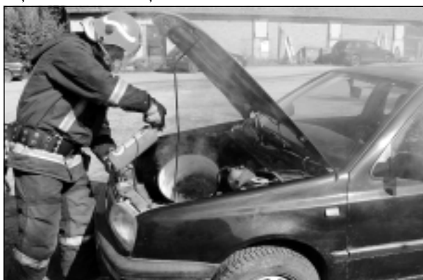
Dzēs ar putām. Nereti nākas pielietot arī ugunsdzēsamo aparātu, lai likvidētu ugunsgrēku automašīnas motora telpā.
