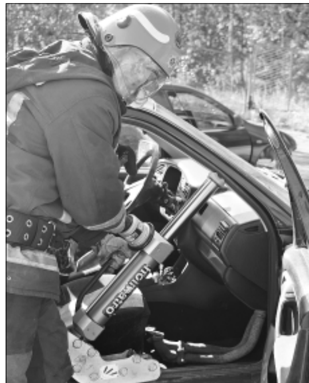
Pielieto hidrocilindru (domkratu). Hidrocilindrus, atkarībā no to konstrukcijas un komplektācijas, ugunsdzēsēji glābēji pielieto, lai izveidotu eju sagruvumos, kravas atplešanā, savilkšanā, pacelšanā un noturēšanā fiksētā stāvoklī. Attēlā redzamajā gadījumā hidrocilindrs tiek izmantots, lai paplašinātu automašīnas konstrukcijas un varētu atbrīvot cietušo no automašīnas.
