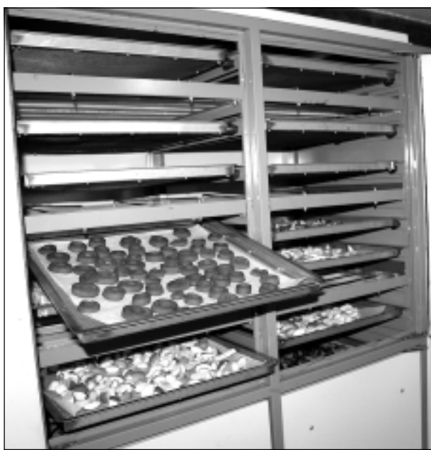
Žāvētājs. Žāvējamajā skapī izmanto metāla sietu paplātes, uz kurām saber žāvējamus augus vai sagrieztos augļus un dārzeņus un žāvē konkrētā temperatūras režīmā. Tējas parasti žāvē 25 - 35 grādu temperatūrā, kas atbilst dabiskās temperatūras apstākļiem. Atrast atbilstošo režīmu palīdz arī pieredze, kas rodas darbojoties. Pēc tam jā rūpējas par žāvējumu pareizu uzglabāšanu, lai tie nebojātos.
