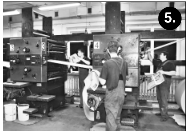
5. Drukā. Piecus tūkstošus laikraksta "Vaduguns" numurus nodrukā apmēram 20 minūtēs uz Zviedrijā ražotām iekārtām "Solna Circulator".
