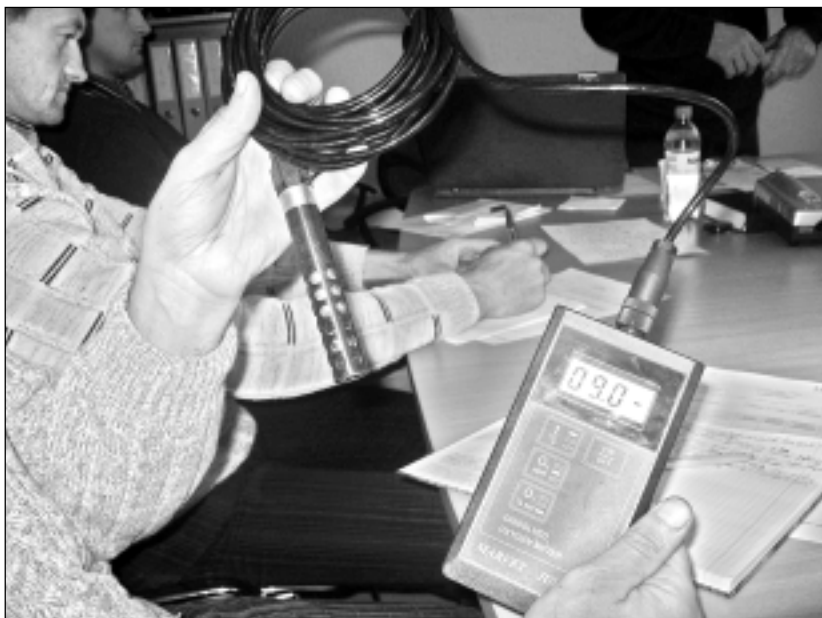
Skābekļa mērparāts. Zivkopis iepazīstināja ar oksimetru – skābekļa mērāmo aparātu, kas lieti noder diķu apsaimniekotājiem. Ar tā palīdzību izmēra skābekļa daudzumu ūdenstilpnē. Ziemas mēnešos to iesaka darīt vismaz reizi nedēļā.
