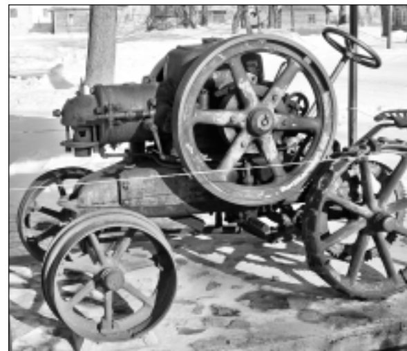
Naftas motors. Naftas motors "Lanz", kas izstādīts muzeja teritorijā, ražots Vācijā 20.gadsimta 20-tajos gados Heinrika Lanza uzņēmumā. Atvests no Ludzas rajona Malnavas pagasta, izmantots kā motors kuļmašīnu, gateru, dzirnavu darbināšanai un kā lielu kravu vilcējs. Dažkārt izmantots zemes darbos.
