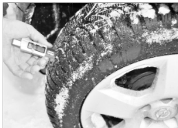
Pārbauda riepas "veselību". Pielietojot riepu protektoru dziļuma mērīšanas ierīci, riepas "temperatūru" var noteikt precīzi un galvenais - ātri.
