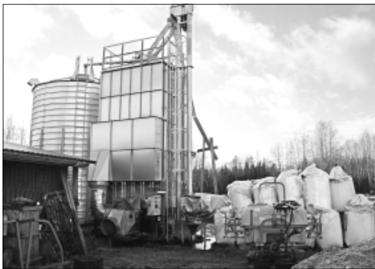
Lauku ražotne. Viens no jaunākajiem ieguldījumiem zemnieku saimniecībai ir kaltes un graudu uzglabāšanas torņa uzstādīšana. Būtu nepieciešams uzbūvēt vēl šķūni, lai kalte būtu zem jumta.
